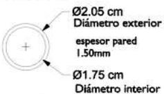
estos tubos van ensamblados a la estructura por medio de soldadura tipo Mig. Electrodo 60000psi
